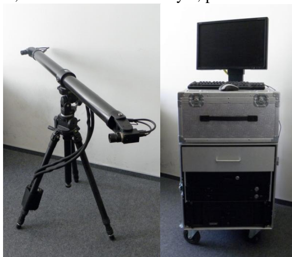
Rys.7. Skaner optyczny 3D z lewej: zestaw kamer, z prawej: jednostka sterująca
